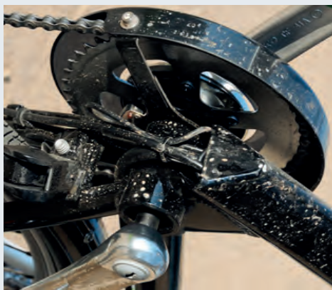
Kabely jsou vedeny dolní rámovou trubkou a voda ani bláto jim neuškodí
