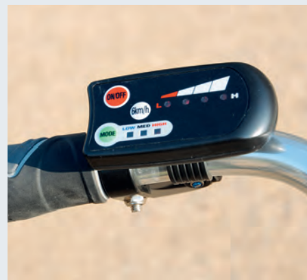
Řídicí jednotka umožňuje rozjezd rychlostí 6 km/h
